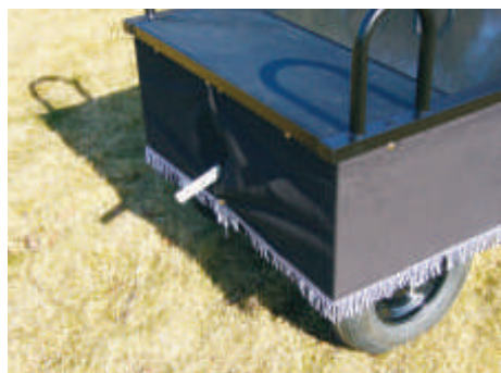
Serienmäßige Feststellbremse auf die Hinterräder wirkend
